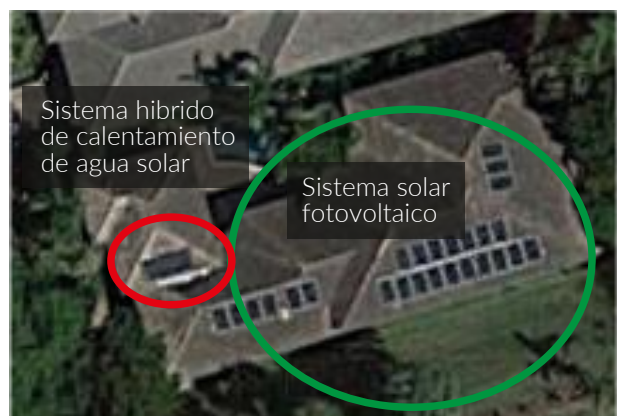
Figura IV3 Configuración sistemas de conversión de energía solar.
